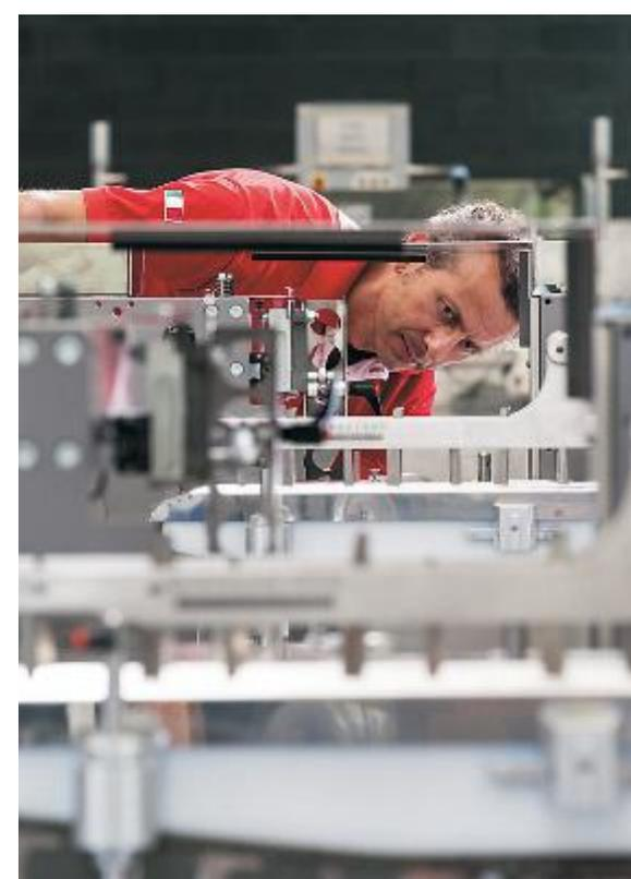
Qui sopra, il particolare di un'astuciatrice Ima, con un addetto al lavoro per verificarne il corretto funzionamento
