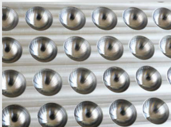
Calotte sferiche con fresatura di precisione ( \varnothing = 5 \text{ mm} )
