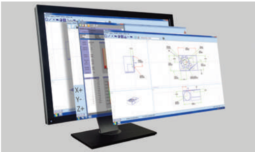
Progettato sulla base di un'interfaccia grafica semplice, Aberlink 3D può funzionare in 2D o 3D, su CMM manuali o CNC. Il modulo CAD offre la possibilità di confrontare i punti misurati con un modello matematico.
