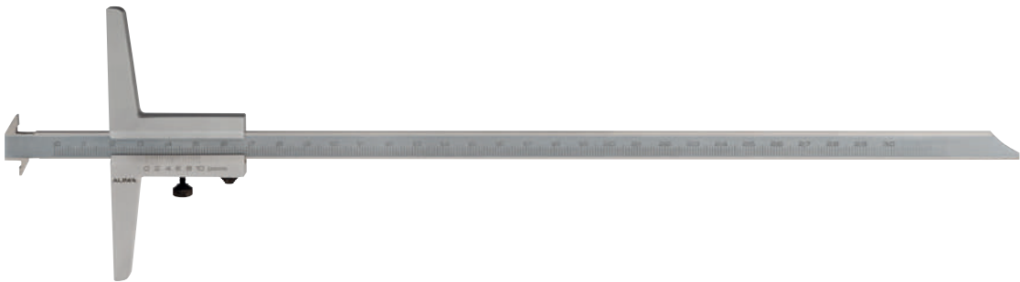
Calibro monoblocco di profondità con doppio piedino Nonio 1/20. Lettura 0,05 mm. Corsoio con vite di bloccaggio.
