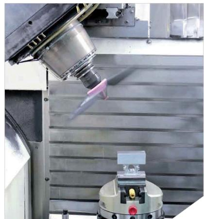
Le pale della Clean Tec si aprono automaticamente grazie alla velocità di rotazione del mandrino della macchina.
